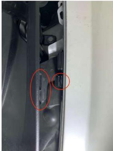
Abbildung 5: Klemme am Rand der Plastikverkleidung
