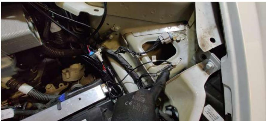
Abbildung 26: Schraube zum Abgreifen der Masse
