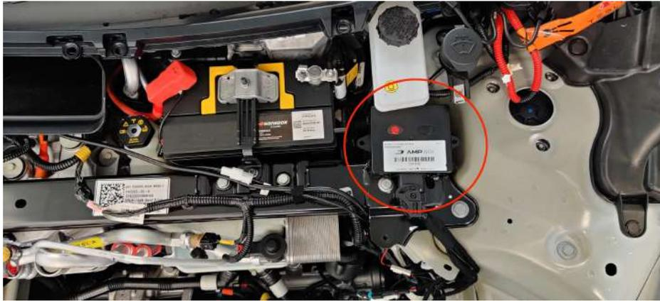
Abbildung 22: Anbringung der Steuereinheit
