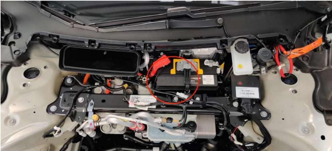
Abbildung 25: Stromadapterkabel am positiven Pol der Batterie
