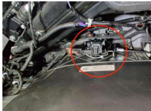
Abbildung 16 und 17: Anbringung des Bowdenzugmotors
