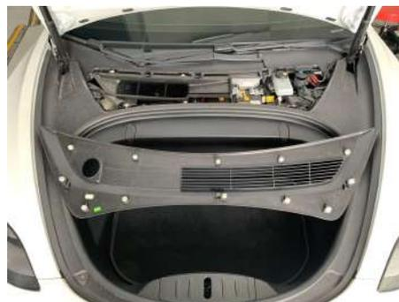
Abbildung 1: Klemmen der Plastikverkleidung
