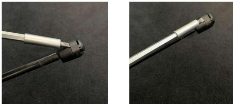
Abbildung 6: Hebeln des Sicherungssplints am Hubarm
