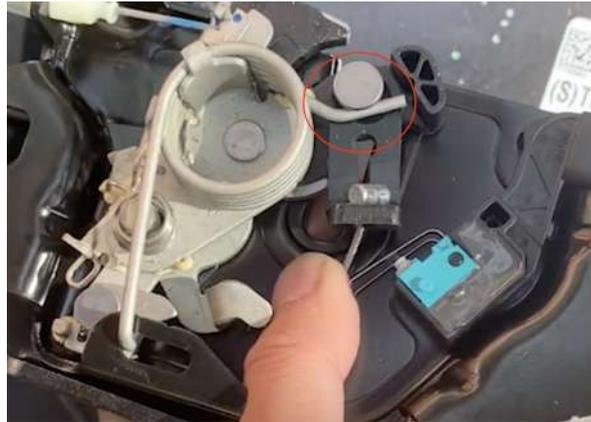
Abbildung 10: Feder der Schlosseinheit
