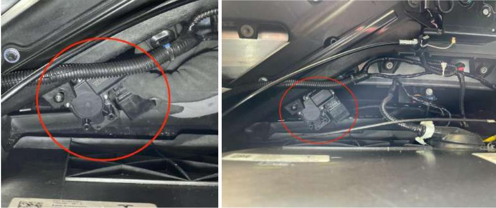
Abbildung 18 (links) und 19 (rechts): Anbringung Softclose Motor
