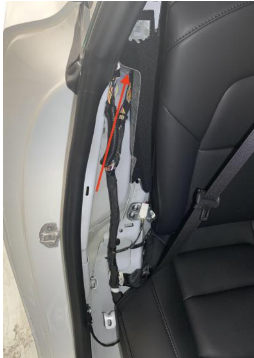
Abbildung 19: Durchführung des Massekabels
