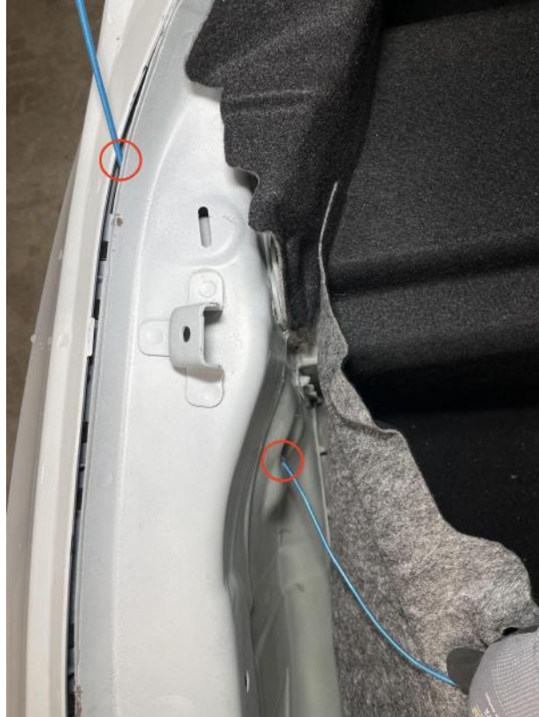
Abbildung 6: Durchführung der Einziehhilfe auf der linken Fahrzeugseite
