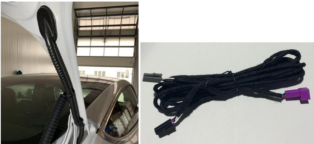
Abbildung 9: Kabelschlauch und Signalkabelbaum
