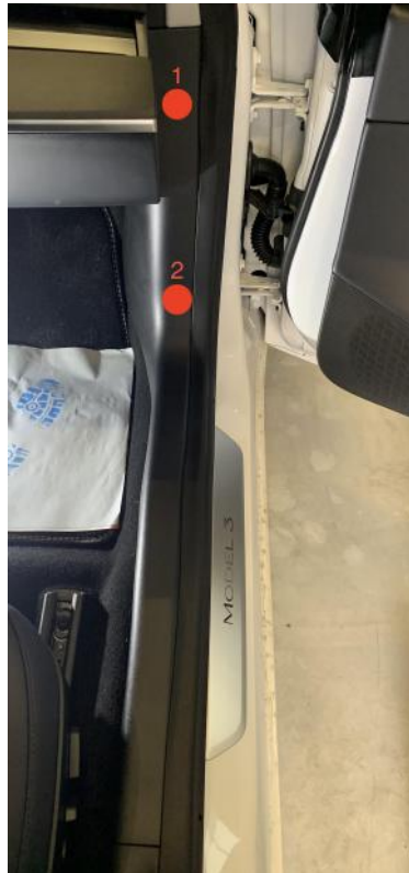
Abbildung 16: Zu entfernende Plastikverkleidungen
