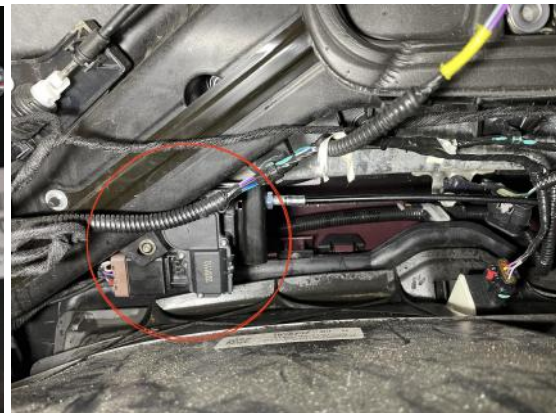
Abbildung 14: Öffnung für das Gewinde drehen (links) und Schraubbefestigung des Bowdenzugmotors (rechts)
